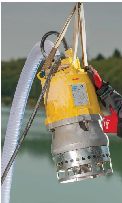
Typische dompelpomp zoals gebruikt bij open bemalingen (met dank aan Atlas Copco)
